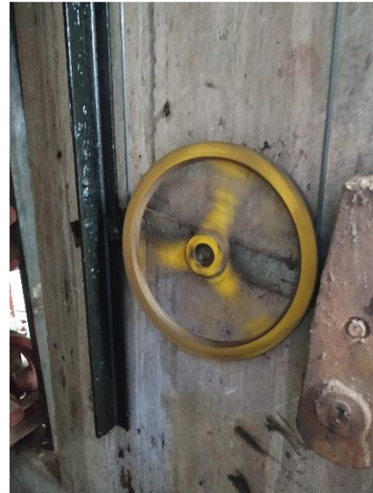
Polea de tracción y polea de desvío. La misma se encuentra en malas condiciones.
