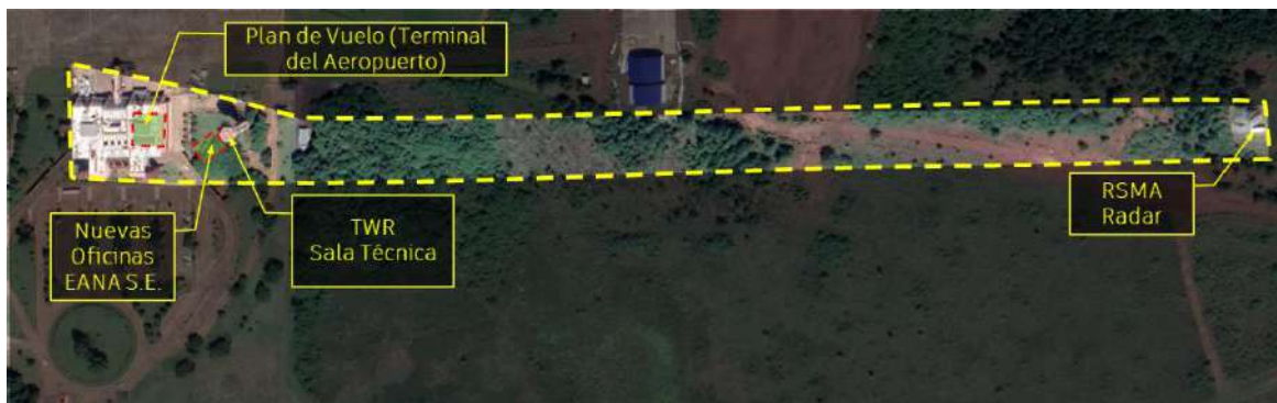
IMAGEN 6: Representación de conexión de fibra óptica entre la terminal del aeropuerto con el Radar.
