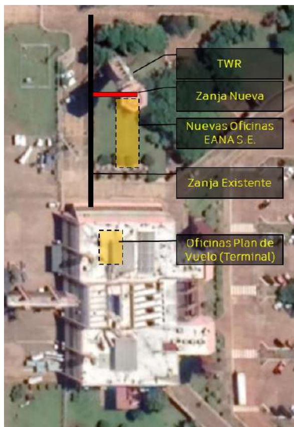
IMAGEN 8: representación de conexión de fibra óptica entre edificios
