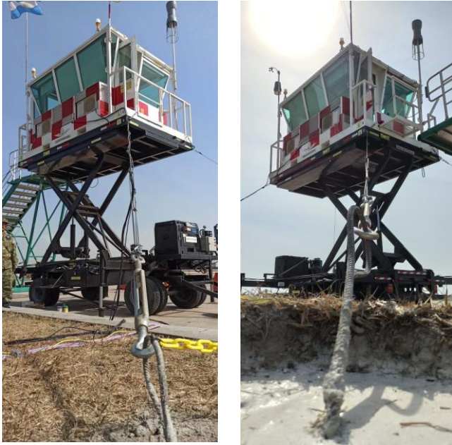
A modo de ejemplo. Placas metálicas de anclaje para arriostamiento de TWR FAA
