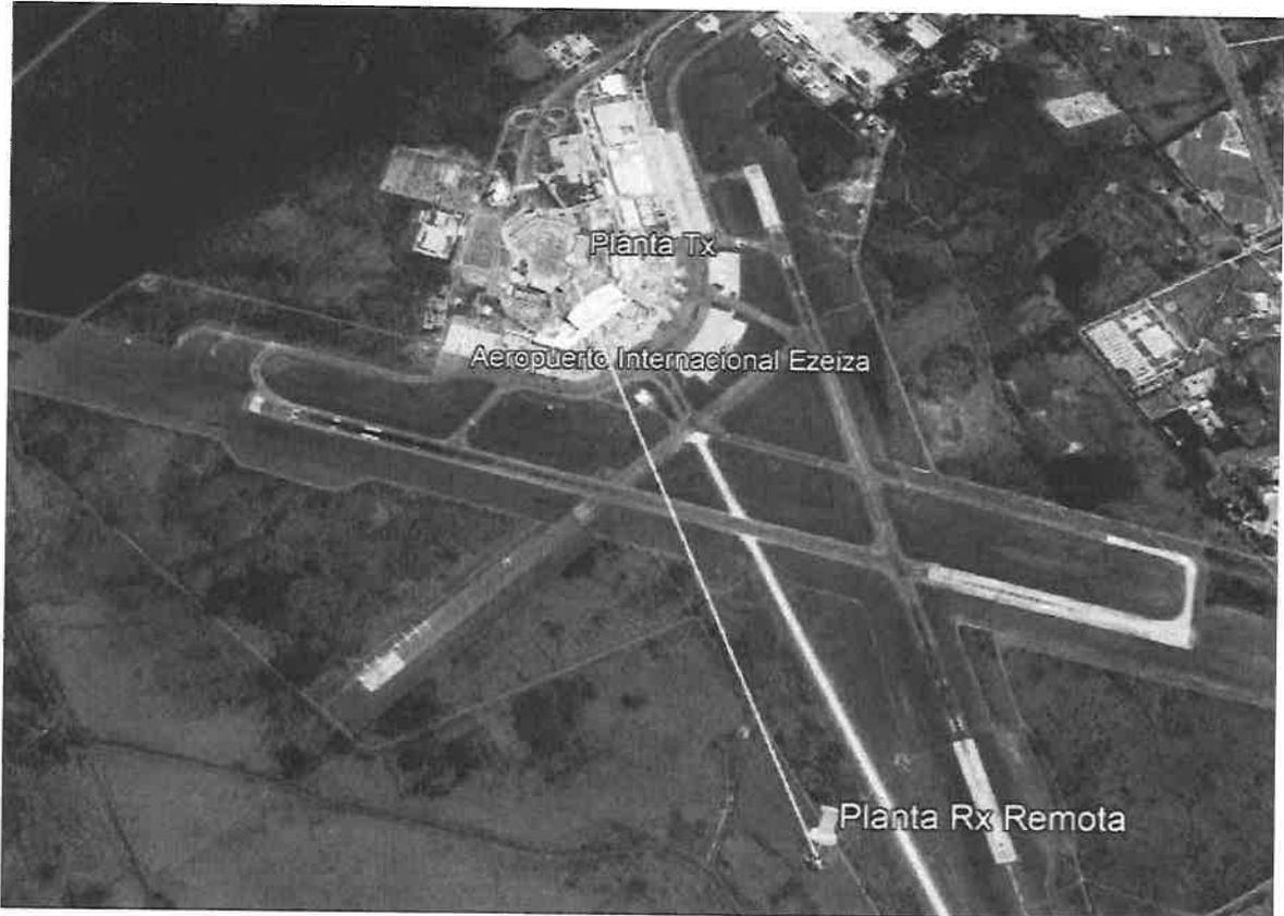
El sistema deberá operar en banda licenciada de 23 GHz, con capacidad de transporte de datos en interfaces Ethernet y, opcionalmente, PDH nativo. La solución deberá implementarse en configuración redundante tipo 1+1 con protección por hardware, garantizando continuidad operativa ante fallas.
